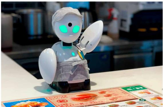
「ゆっくりレジ」で活躍するOriHime。OriHimeはカメラとマイクを備え、手と首を愛しく動かせる。AIではなく、人が遠隔コミュニケーションするロボットだ(写真提供：株式会社オリィ研究所)
