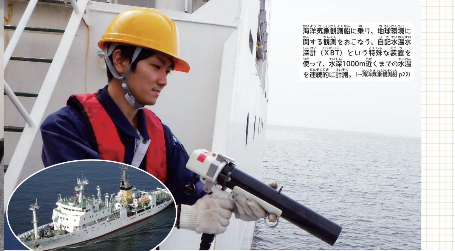
海洋気象観測船に乗り、地球環境に関する観測をおこなう。自記水温水深計(XBT)という特殊な装置を使って、水深1000m近くまでの水温を連続的に計測。(→海洋気象観測船 p22)
